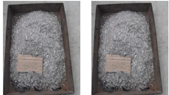
Gambar 2. Cacahan plastik Ø 2.36 dan Ø 1.18 mm
