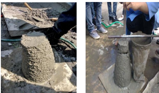
Gambar 3. Pengujian slump beton
